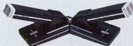
N 8403 (N 8404) HiFi Stereo-Electret-Mikrofon für alle Philips Stereo-Cassetten-Recorder und Stereo-Spulengeräte. Mit 2 trennbaren Systemen. Empfindlichkeit: 2 x 0,25 mV/μbar. Frequenzbereich: 50–15 000 Hz (DIN 45 500). Impedanz: 2 x 800 Ohm. Ausführung: mit 5pol. 180°-DIN-Stecker. DM 75,—*
