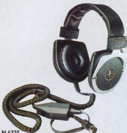
N 6325 HiFi Electret-Stereo-Kopfhörer zum Anschluß an Tonbandgeräte, HiFi-Verstärker und Fernsehgeräte. Electret-Kondensatorprinzip. Frequenzbereich: 20–22 000 Hz Impedanz: 1000 Ohm bei 500 Hz. Gewicht 230 g. Ausführung: Klinkenstecker 6,3 mm. Mit beiliegendem Adapter zum Umrüsten auf 5pol. 360°-DIN-Kopfhörerstecker. DM 98,—
