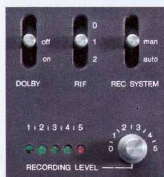
Übersichtliches Bedienungsfeld mit Funktionsschalter für das rauschunterdrückende DOLBY-System, für R I F und wahlweise Automatik- oder Handaussteuerung durch Einsteller und Leuchtdiodenkette.
