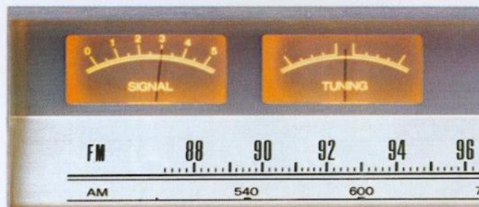
Feldstärke-Instrument (Signal) und Anzeige der Sender-Abstimmmitte (Tuning).
