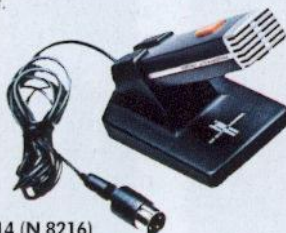
N 8214 (N 8216) HiFi-Electret-Mikrofon mit Schalter Kugelcharakteristik. Empfindlichkeit: 0,25 mV/μbar. Frequenzbereich: 50–15 000 Hz (DIN 45 500). Impedanz: 800 Ohm. Ausführung: N 8214/00 mit 3pol. 180°-DIN-Stecker mit Ein/Aus-Schalter für das Mikrofonsignal N 8216 (o. Abb.) mit 2 Klinkensteckern, 3,5 mm für die NF, 2,5 mm für Start/Stop DM 32,—*
