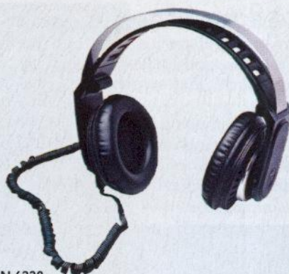
N 6330 HiFi Stereo-Kopfhörer Eine aktive Membrane und sechs passive Membranen bilden eine extrem große Abstrahlfläche und bieten damit einen hervorragenden Klangeindruck, besonders bei tiefen Frequenzen. Ausführung: 5pol. 360°-DIN-Kopfhörerstecker. Mit beiliegendem Adapter zum Umrüsten auf Klinkenstecker. Frequenzbereich: 16–20 000 Hz (DIN 45 500). Impedanz: 2 x 600 Ohm. Gewicht: 400 g. DM 198,—*
