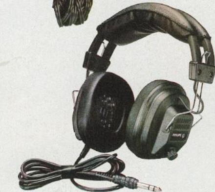
N 6325 HiFi-Electret-Stereo-Kopfhörer zum Anschluß an Tonbandgeräte, HiFi-Verstärker und Fernsehgeräte. Electret-Kondensatorprinzip. Frequenzbereich: 20–22 000 Hz Impedanz 1000 Ohm bei 500 Hz. Gewicht 230 g. Ausführung: Klinkenstecker 6,3 mm. Mit beiliegendem Adapter zum Umrüsten auf 5 pol. 360° DIN Kopfhörerstecker. DM 98,—
