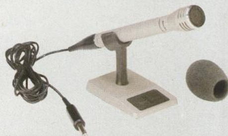
N 8501 HiFi-Electret-Mikrofon Super-Nierencharakteristik. Empfindlichkeit: 0,35 mV/µbar. Frequenzbereich: 50–18 000 Hz (DIN 45 000). Ausführung: Klinkenstecker 6,3 mm. Mit Tischstativ und Windschutz für Nahbesprechung. Stativgewinde 3/8". DM 125,—*
