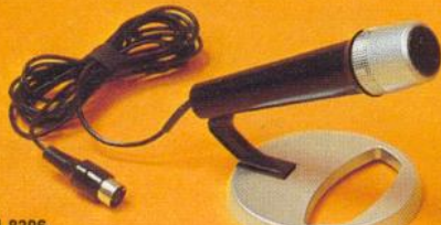
N 8306 Dynamisches Mikrofon für alle Geräte. Nierencharakteristik. Empfindlichkeit: 0,27 mV/ \mu bar. Frequenzbereich: 100–18 000 Hz. Impedanz: 500 Ohm. Stativgewinde \frac{3}{8} ". DM 50,—*
