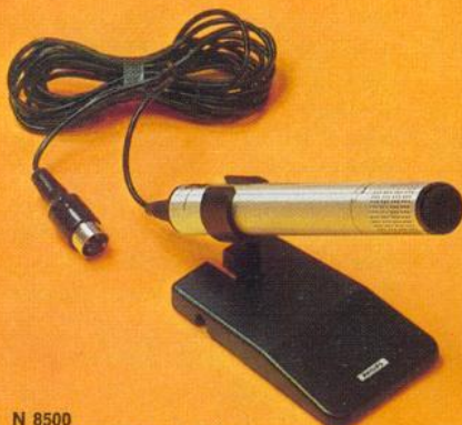
N 8500 HiFi-Electret-Mikrofon für alle Geräte. Nierencharakteristik. Empfindlichkeit: 0,25 mV/ \mu bar. Frequenzbereich: 100–16 000 Hz (nach DIN 45500). Mit Tischstativ, Windschutz für Nahbesprechung. DM 140,—*
