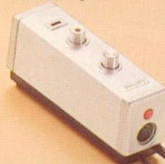
N 6400 Dia-Steuergerät zur Steuerung automatischer Projektoren. Für alle Tonbandgeräte. Impulslage auf Spur 4. Impulsfrequenz ca. 1000 Hz. Transistorisiert. Batteriebetrieb (mehr als 100 Std. Betriebsdauer). Drucktastensteuerung. Löschanzeige. Impulslöschung. Höhenverstellung. DM 145,—*
