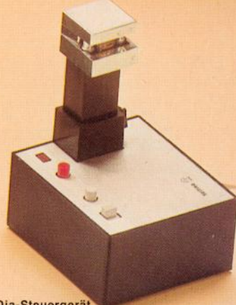
N 6400 Dia-Steuergerät zur Steuerung automatischer Projektoren. Für alle Tonbandgeräte. Impulslage auf Spur 4. Impulsfrequenz ca. 1000 Hz. Transistorisiert. Batteriebetrieb (mehr als 100 Std. Betriebsdauer). Drucktastensteuerung. Löschanzeige. Impulslöschung. Höhenverstellung. DM 145,—*
