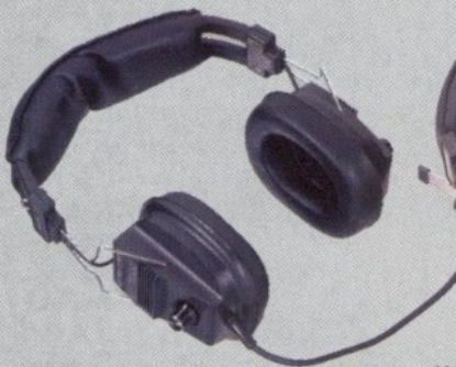
N 6306 Stereo-Kopfhörer Lautstärkeregelung an jeder Kapsel Frequenzbereich: 20–12 000 Hz Impedanz: 2 x 8 Ohm Gewicht: 350 g Ausführung: Klinkenstecker 6,3 mm DM 27,50*
