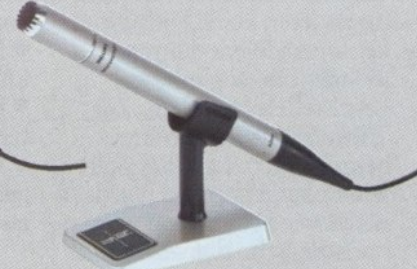
N 8310 HiFi-Electret-Mikrofon Kugelcharakteristik. Empfindlichkeit: 0,3 mV/μbar. Frequenzbereich: 20–20 000 Hz Impedanz: 800 Ohm Ausführung: Klinkenstecker 6,3 mm DM 90,-*
