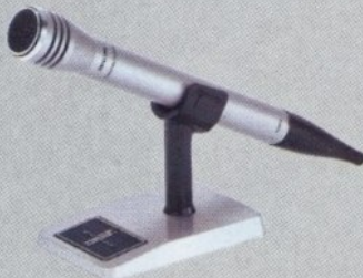
N 8501 HiFi-Electret-Mikrofon Super-Nierencharakteristik. Empfindlichkeit 0,35 mV/μbar. Frequenzbereich: 50–18 000 Hz Impedanz: 1200 Ohm Ausführung: Klinkenstecker 6,3 mm DM 125,-*
