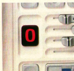
Bereitschaftsschaltung Über Ultraschall-Fernbedienung kann das Gerät auf Bereitschaftsbetrieb geschaltet werden. In der Programmanzeige leuchtet die „0“ auf. Das heißt: Bild und Ton sind abgeschaltet, erscheinen aber auf Tastendruck sofort wieder.
