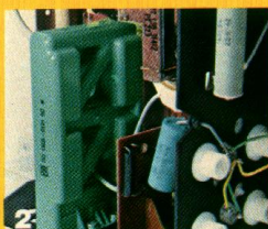
25.000-Volt-Kaskade mit Silizium-Dioden: stabil und zuverlässig.
