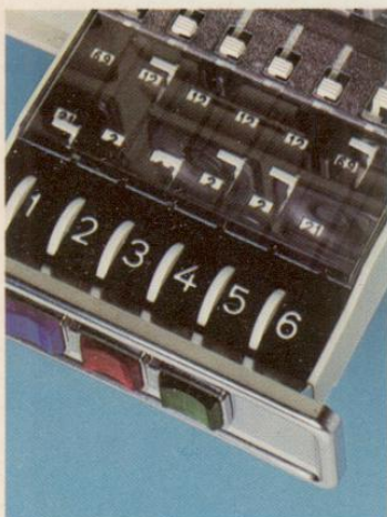
Memomatic-Programmspeicher Alle erreichbaren Sender einspeichern — „Schublade“ zuschieben — fertig. Kein unbeabsichtigtes Verstellen möglich.
