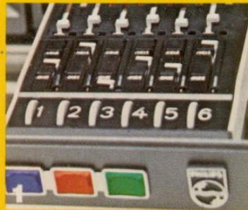
Memomatic Speicher-Modul — speichert nach einmaliger Vorwahl die optimale Einstellung jedes Fernseh-Senders.
