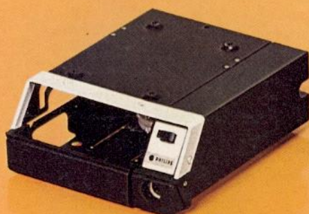
N 6705 Auto-Einbaueinheit für Cassetten-Recorder EL 3302 plus und N 2203. Betrieb über die 6- bzw. 12-Volt-Anlage. Anschluß an das Autoradio. Breite 180 mm, Höhe 75 mm, Tiefe 225 mm. DM 95,- *
