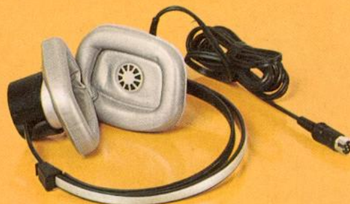
LBB 9902 HiFi-Stereo-Kopfhörer für N 4416, N 4418, N 4510, N 4450 sowie zum Anschluß an HiFi-Verstärker. Frequenzbereich: 20–20 000 Hz. Klirrfaktor bei Vollaussteuerung 1 %. Gewicht 340 g. Auch für Unterkinbetrieb geeignet. DM 79,— *
