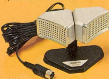
N 8402 Dynamisches Stereo-Mikrofon für N 2400, N 2401 S, N 2405, N 2506, N 2510, N 4414, N 4416, N 4418, N 4510 und N 4450. Mit 2 trennbaren Systemen, Nierencharakteristik. Empfindlichkeit: 0,33 mV/ \mu bar. DM 75,— *
