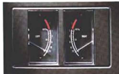
To belyste VU-metre giver let kontrol af indspilningsstyrken på de to kanaler.
