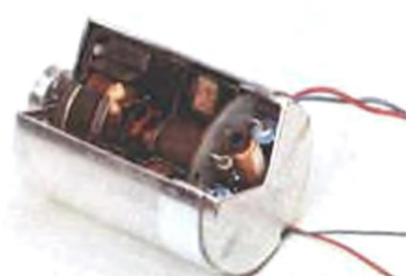
Tacho-motoren er en højtudviklet elektronisk styret motor, som sikrer konstant båndhastighed.
