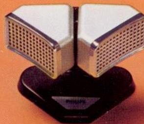
N 8402 Dynamisches Stereo-Mikrofon für N 2401 S, N 2407, N 2506, N 2509, N 2510, N 4414, N 4416, N 4418, N 4510 und N 4450. Mit 2 trennbaren Systemen, Nierencharakteristik. Empfindlichkeit: 0,33 mV/μbar.
