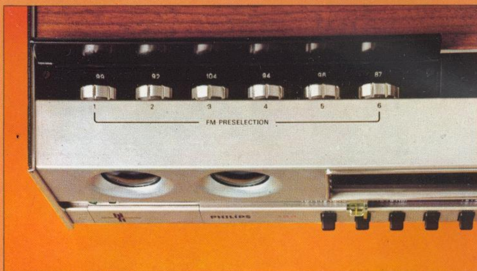
Abstimmregler für die Philips Electronic-Memomatic zur UKW-Programmspeicherung.
