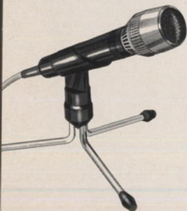
LBB 9500 Dynamische HiFi-microfoon. Frequentiebereik: 40–19.000 Hz. Gevoeligheid: 0,27 mV/ \mu bar. Impedantie: 500 \Omega . Compleet met tafelstatief.
