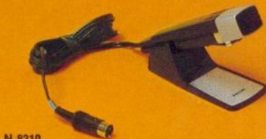
N 8210 Dynamisches Mikrofon mit Start/Stop-Schalter für EL 3302 plus, N 2203, N 2204, N 2205, N 2209 AV, N 2211, N 2221, N 2225. Kugelcharakteristik. Empfindlichkeit: 0,27 mV/ \mu bar. Frequenzbereich: 63–17 000 Hz. Impedanz: 500 Ohm. DM 33,—*
