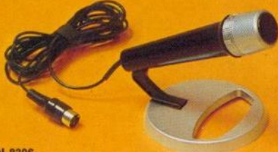
N 8306 Dynamisches Mikrofon für alle Geräte. Nierencharakteristik. Empfindlichkeit: 0,27 mV/ \mu bar. Impedanz: 500 Ohm. Stativgewinde \frac{3}{8} ". DM 50,—*
