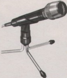
LBB 9500 Dynamische HiFi-microfoon. Frequentiebereik: 40–19.000 Hz. Gevoeligheid: 0,27 mV/ \mu bar. Impedantie: 500 \Omega . Compleet met tafelfstatief.
