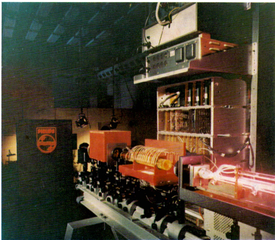
Abbildung 1 Laboranordnung zur digitalen Steuerung eines Laserstrahls mit elektrooptischen Elementen, sogenannten Kerr-
