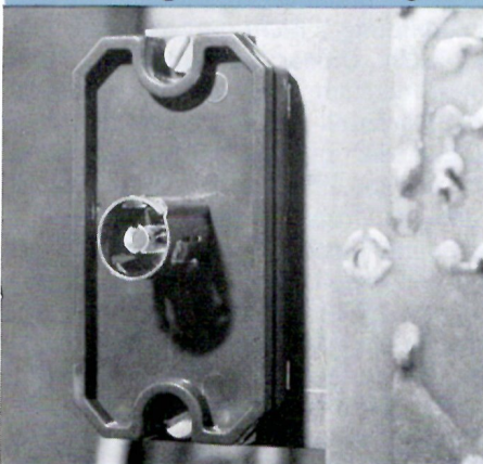
Die unverwechselbare Koax-Normbuchse erlaubt eine abgeschirmte übertragerlose Antennensignalführung.
