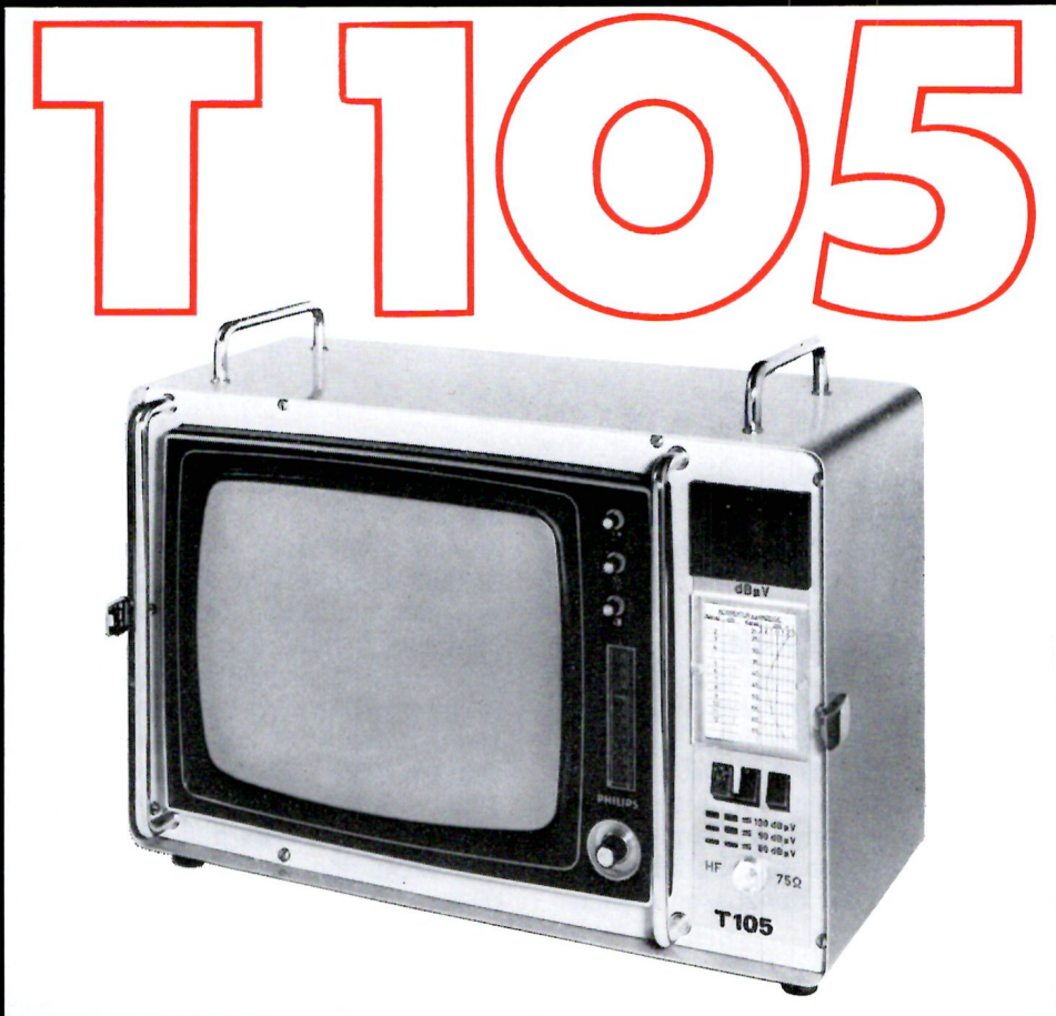
Abbildung 1 Philips Fernsehantennen-Prüfempfänger T 105 mit digitaler Anzeige in \text{dB}\mu\text{V} , selbstabgleichender Brückenschaltung und 31-cm-Kontrollbildschirm.
