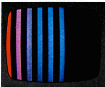
Bild 4.2-15. Schirmbild mit fehlender (G - Y)-Komponente bei getastetem Regenbogensignal
