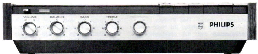
Abbildung 4 Gehäusevorderseite mit den Einstellern für Lautstärke, Balance, Bässe, Höhen und Aussteuerung. Oberhalb des ersten Knopfes befinden sich die Netztaaste und das Einschaltkontroll-Lämpchen.
