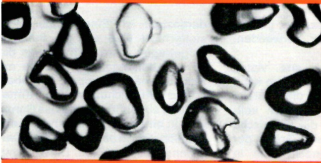
Abbildung 2 a) Draufsicht und b) Schnitt einer photoleitenden CdS-Folie, unter dem Mikroskop betrachtet.
