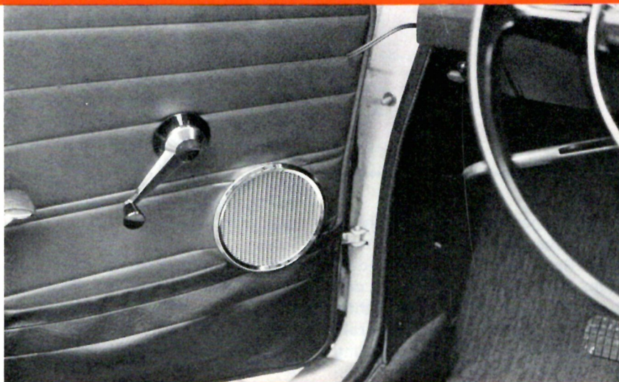
Abbildung 9 Teilansicht der Auto-Stereoanlage mit einem vorderen Tür Lautsprecher und einem der beiden auf dem Armaturenbrett befestigten Frontlautsprecher, dessen Abstrahlfläche auf die Insassen gerichtet ist. Dreht man ihn um 90 Grad nach oben, so wird der Schall von der Windschutzscheibe zurückgeworfen.
