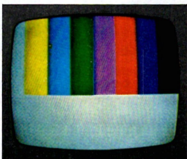
Bild 4.2-16. Schirmbild mit fehlender (G - Y)-Komponente bei RGB-Farbbalkensignal
