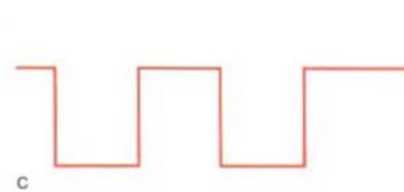
Starkes Rauschen maskiert Analogsignale (a, b), nicht aber die Nullen und Einsen eines Digitalsignals (c, d).
