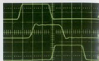
Deze oscillogrammen laten de voordelen zien van Philips digitale precisiefiltering. A. Hoorbaar testsignaal bij opname. B. Waarneembare vervorming bij toepassing van conventioneel analog filter. C. Onvervormd Compact Disc uitgangssignaal door toepassing van unieke Philips digitale precisiefiltering.
