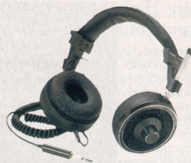
N 6315 Stereo-Kopfhörer zum Anschluß an Tonbandgeräte, Verstärker und Fernsehgeräte. Frequenzbereich: 20–17 000 Hz, Gewicht 300 g. Ausführung: Klinkenstecker 6,3 mm. Lautstärkeregelung an jeder Kapsel. Impedanz 2 x 16 \Omega . DM 59,—
