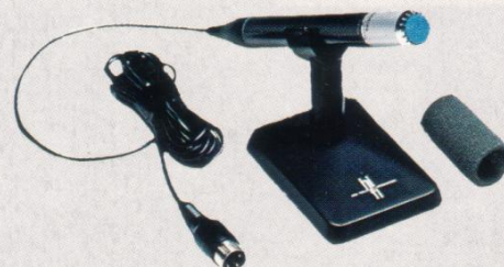
N 8310 HiFi-Electret-Mikrofon Kugelcharakteristik. Empfindlichkeit: 0,3 mV/ \mu bar. Frequenzbereich: 20–20 000 Hz (DIN 45 500). Mit Tischstativ und Windschutz für Nahbesprechung. Stativgewinde 3/8". Ausführung: Klinkenstecker 6,3 mm. DM 90,—
