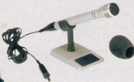
N 8501 HiFi-Electret-Mikrofon Super-Nierencharakteristik. Empfindlichkeit: 0,35 mV/ \mu bar. Frequenzbereich: 50–18 000 Hz (DIN 45 500). Ausführung: Klinkenstecker 6,3 mm. Mit Tischstativ und Windschutz für Nahbesprechung. Stativgewinde 3/8". DM 125,—
