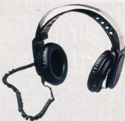
N 6330 HiFi-Stereo-Kopfhörer Eine aktive Membrane und sechs passive Membranen bilden eine extrem große Abstrahlfläche und bieten damit einen hervorragenden Klangeindruck, besonders bei tiefen Frequenzen. Ausführung: Klinkenstecker 6,3 mm. Frequenzbereich: 16–20 000 Hz (DIN 45 500). Impedanz: 2 x 600 Ohm. Gewicht: 400 g. DM 198,—
