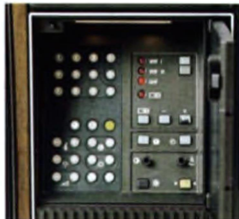
Betjeningspanelet er skjult bag en dør med indbygget lys.
