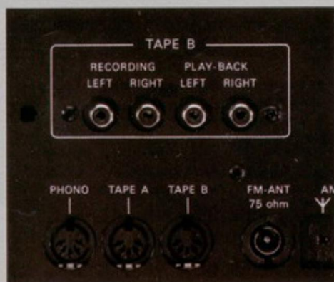
DIN en cinch aansluitingen. DIN voor platenspeler, tape A en tape B. Bovendien cinch voor tape B.
