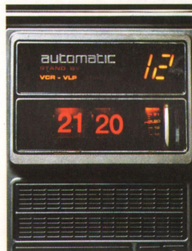
Zweistellige 7-Segment-Leuchtziffer-Programmanzeige. Dazu Digitaluhr mit Schaltautomatic.
