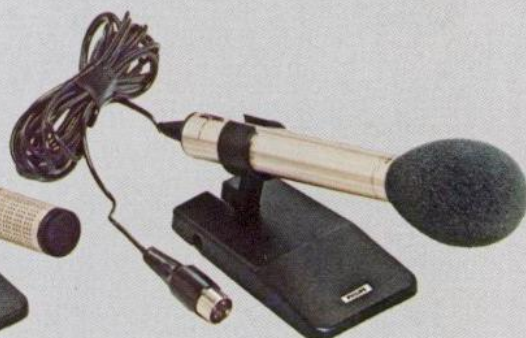
N 8500 HiFi-Electret-Mikrofon für alle Geräte. Nierencharakteristik. Empfindlichkeit: 0,25 mV/ \mu bar. Frequenzbereich: 35–18 000 Hz (nach DIN 45 500). Mit Tischstativ und Windschutz für Nahbesprechung. DM 140,-*.
