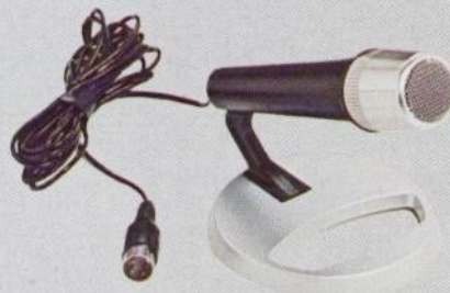
N 8307 Dynamisches Breitband-Mikrofon für alle Geräte. Nierencharakteristik. Empfindlichkeit: 0,24 mV/ \mu bar. Frequenzbereich: 80–20 000 Hz. Impedanz: 500 Ohm. Stativgewinde: \frac{3}{8} ". DM 80,-*.
