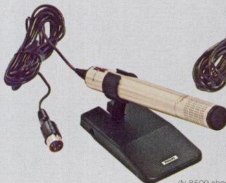
N 8500 HiFi-Electret-Mikrofon für alle Geräte. Nierencharakteristik. Empfindlichkeit: 0,25 mV/ \mu bar. Frequenzbereich: 35–18 000 Hz (nach DIN 45 500). Mit Tischstativ und Windschutz für Nahbesprechung. DM 140,-*.
