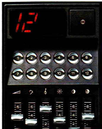
Zweistellige 7-Segment-Leuch- ziffern-Anzeige.
