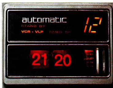
Zweistellige 7-Segment-Leucht-ziffern-Anzeige für 12 Programme. Dazu Digitaluhr mit Schaltautomatic.
