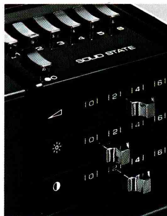
Übersichtliche stufenlose Einstellung von Lautstärke, Helligkeit und Kontrast durch drei leichtgängige Schiebesterler.
