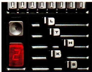
Komfort-Bedienung durch Schiebester für Lautstärke, Ton, Helligkeit, Kontrast und Farbsättigung.
