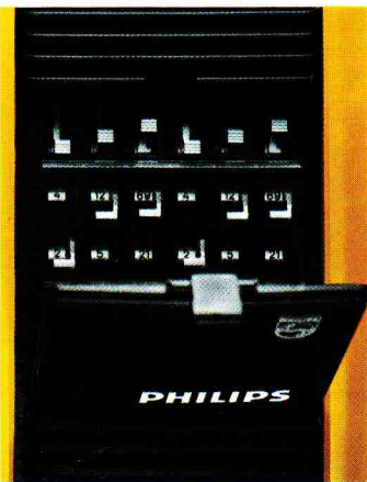
Memomatic-Programmspeicher — seitlich verdeckt — für das Einspeichern der erreichbaren Programme.
