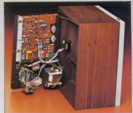
Die herausgeschwenkte Elektronik der RH 532: 1 V Steuerspannung wird in 60 W Sinusleistung umgewandelt. Ergebnis: 105 dB Schalldruck.
