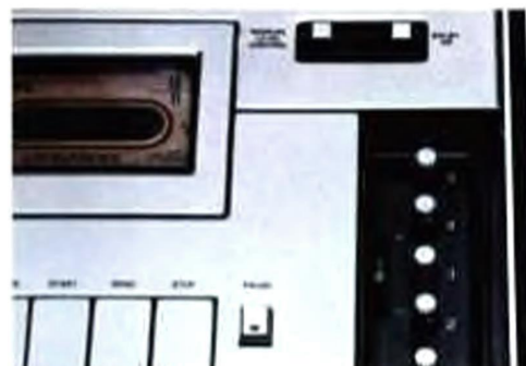
Knapper til forudindstilling af 5 FM-stationer er let tilgængelige på et instrumentpanel.
