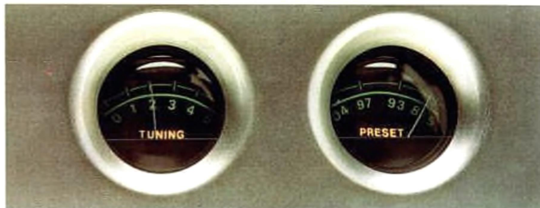
Afstemningsindikator – Ved indstilling af AM/FM stationer, opnår man den bedste gengivelse, når indikatornålen har størst udslag.
