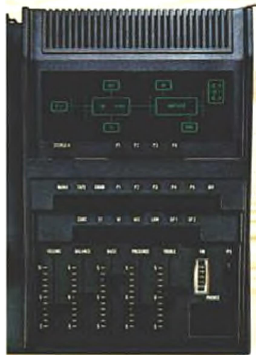
Øverst: Lyspanel med blokdiagram, som viser den øjeblikkelige indstilling. Nederst: Avanceret betjeningspanel med skydeknappe for indstilling af balance-, bas-, mellem- og diskantkontrol.
