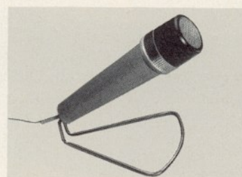
8301 Dynamisches Mikrofon für alle Geräte. Richtcharakteristik: Niere Empfindlichkeit: 0,27 mV/ubar Impedanz: 500 Ohm Stativgewinde 3/8"
