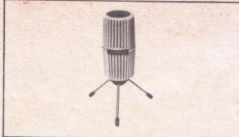
EL 3757 Dynamisches Stereo-Mikrofon mit 2 eingebauten Systemen, Empfindlichkeit 0,20 mV/μbar, Impedanz 500 Ohm (je Kanal), mit Spoligem Normstecker, Stativgewinde 3/8"; für RK 37 und RK 66 DM 120,—*)
