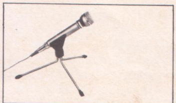
NG 1219 Dynamisches Breitband-Mikrofon Richtcharakteristik: Niere, Frequenzbereich 40 — 16 000 Hz, Empfindlichkeit 0,18 mV/μbar, Impedanz 200 Ohm, für alle Geräte (einschließlich Tisch-Stativ mit 5 m Anschlußkabel) DM 169,—*)
