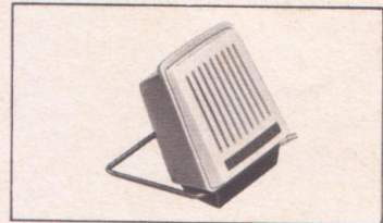
EL 3781 Dynamisches Mikrofon Richtcharakteristik: Kugel, Empfindlichkeit 0,35 mV/μbar, Impedanz 500 Ohm, Stativgewinde 3/8"; für alle Geräte DM 42,—*)
