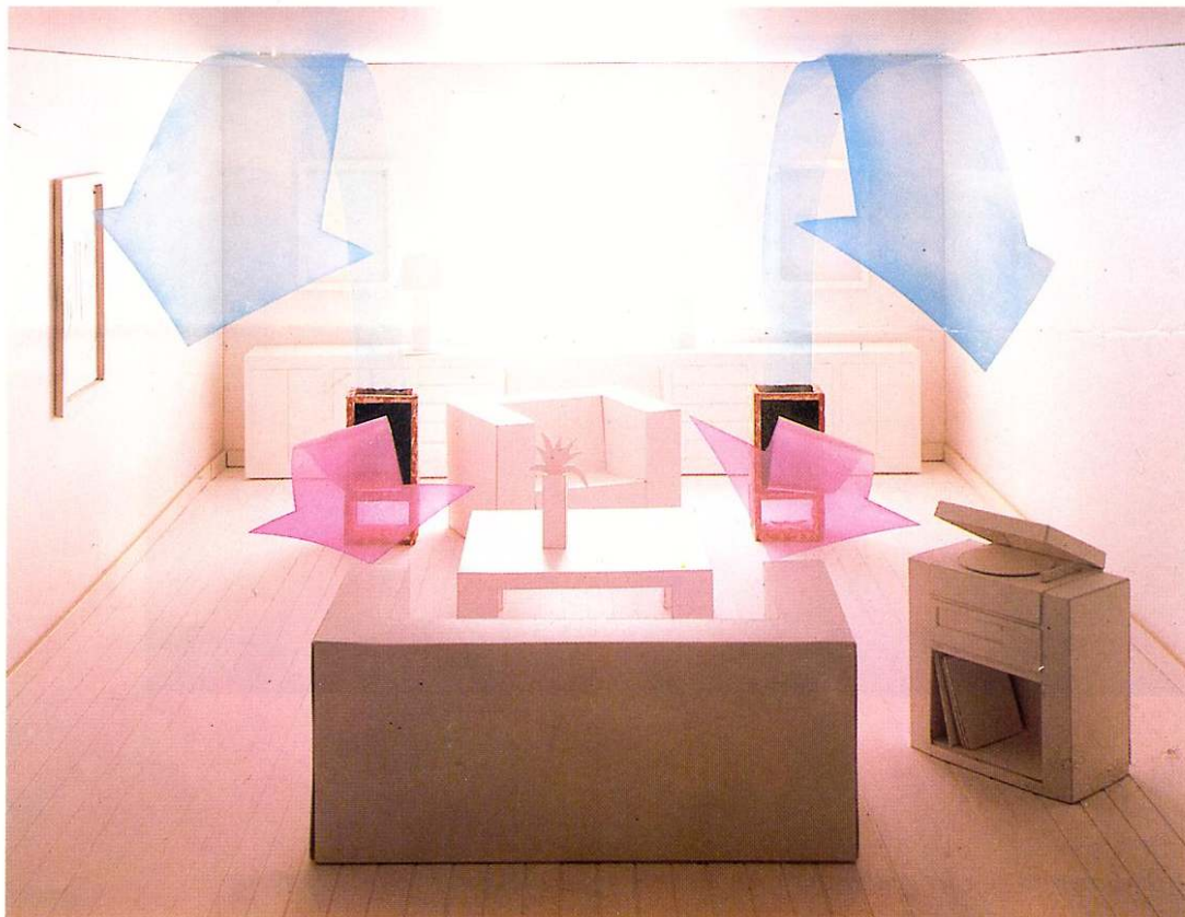
Dieses Modell zeigt die Wirkungsweise einer neuartigen Lautsprecherbox. Dem nach vorn abgestrahlten Direktschall folgt zeitlich verzögert der indirekte Schall, der nach oben abgestrahlt, von Decke und Wänden reflektiert wird.
