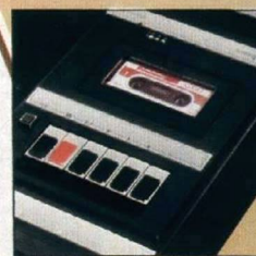
Stereo-Cassetten-Recorder mit Viertelspurtechnik für Stereo- und Mono-Aufnahme und -Wiedergabe. Eingebaut beim ›7020 SC‹. Automatische Umschaltung auf Chromdioxid-Bänder.
