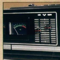
Aussteuerungs-Instrumente Zwei Anzeige-Instrumente und zwei Gleitregler zur getrennten Aussteuerung beider Kanäle bei Aufnahme mit Cassette beim ›7020 SC‹.
