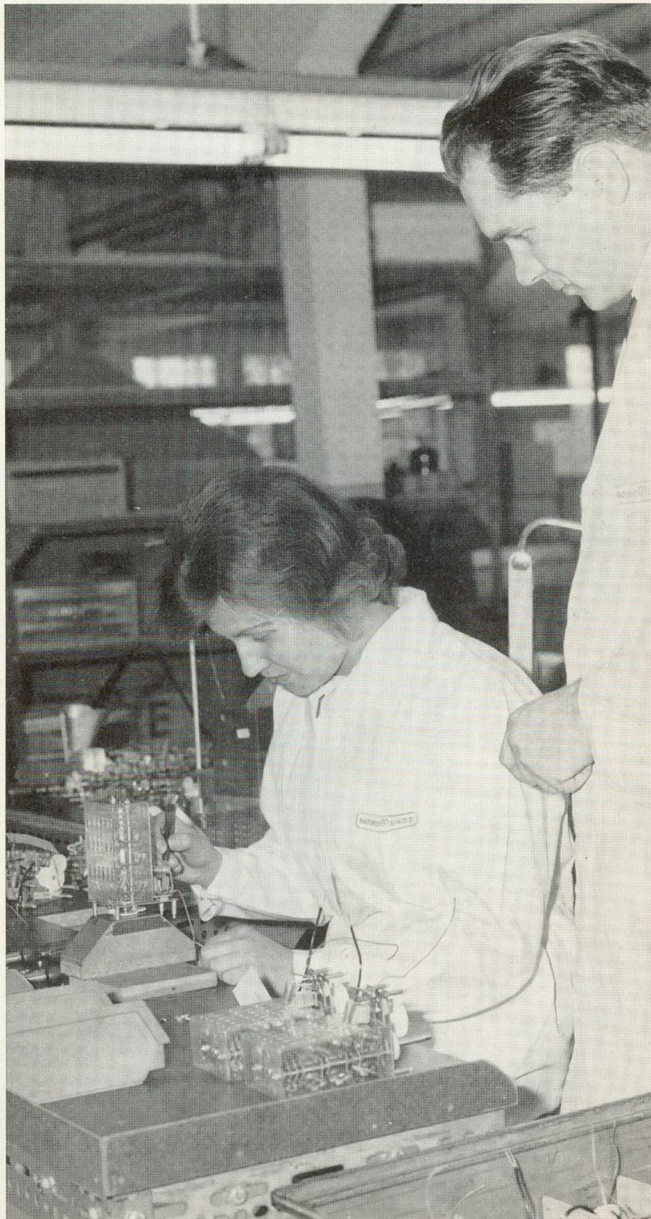
Höchste Präzision verlangen die Kurzwellen-Kanalwählerbausteine der Empfänger „Globetrotter“ beim Abgleichen und Justieren. Besonders für das Prüffeld konstruierte Einrichtungen gewährleisten die sprichwörtliche Empfindlichkeit des beliebten „Globetrotters“.
