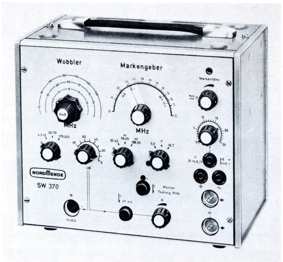
Bild 11: Den in einem platzsparenden „Compact“-Gehäuse untergebrachten neuen Service-Wobbler SW 370 merkt man nicht sofort an, daß er 200 mV Ausgangsspannung abgibt und sich daher trotz des erstaunlich niedrigen Preises für Kanalwähler-Abgleicharbeiten eignet.
