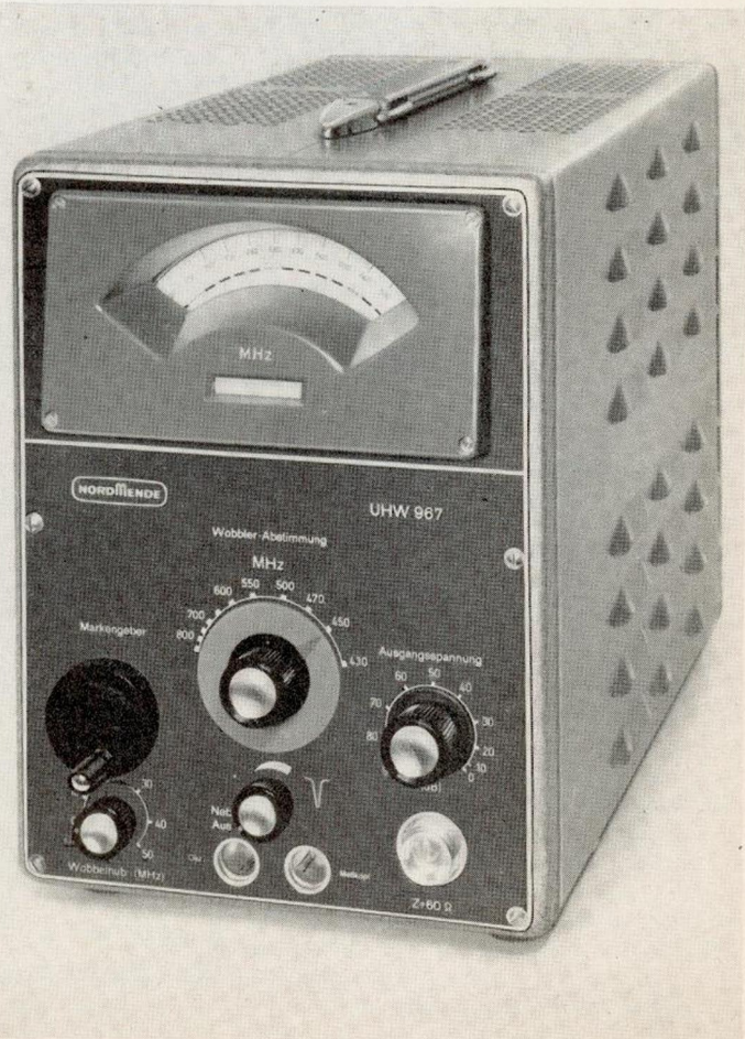
Bild 1 und 2: Fernseh-Signal-Generator FSG 957/II und UHF-Wobbler UHW 967 zur Erzeugung eines eigenen Test-Signales auf dem VHF- und UHF-Bereich.
