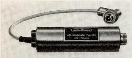
Bild 3: AM-Modulator als Verbindungsglied zwischen dem FSG 957/II und dem UHW 967.
