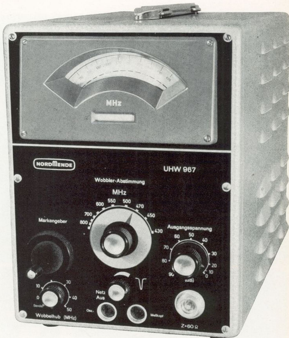
Bild 1: Der Nordmende-UHF-Wobbler UHW 967, mit dem der Techniker alle mit UHF zusammenhängenden Fragen und Meßaufgaben ohne Schwierigkeiten lösen kann.
