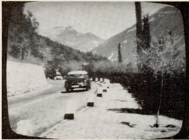
Bild 80: Auch beim Bild einer Live-Sendung sind rechts neben dem Fahrzeug die „Fahnen“ sichtbar
