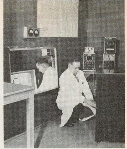
In fast allen Kanälen einschließlich UHF kann ein Gerät in dieser Kabine kontrolliert werden. Die verschiedenen Testbilder ermöglichen u. a. die Prüfung der Nachstimm- und Zeilenautomatik, der Mikrophonesicherheit, der Brummstörungen in Bild und Ton, der Nachbarkanalunterdrückung und der Bildauflösung
