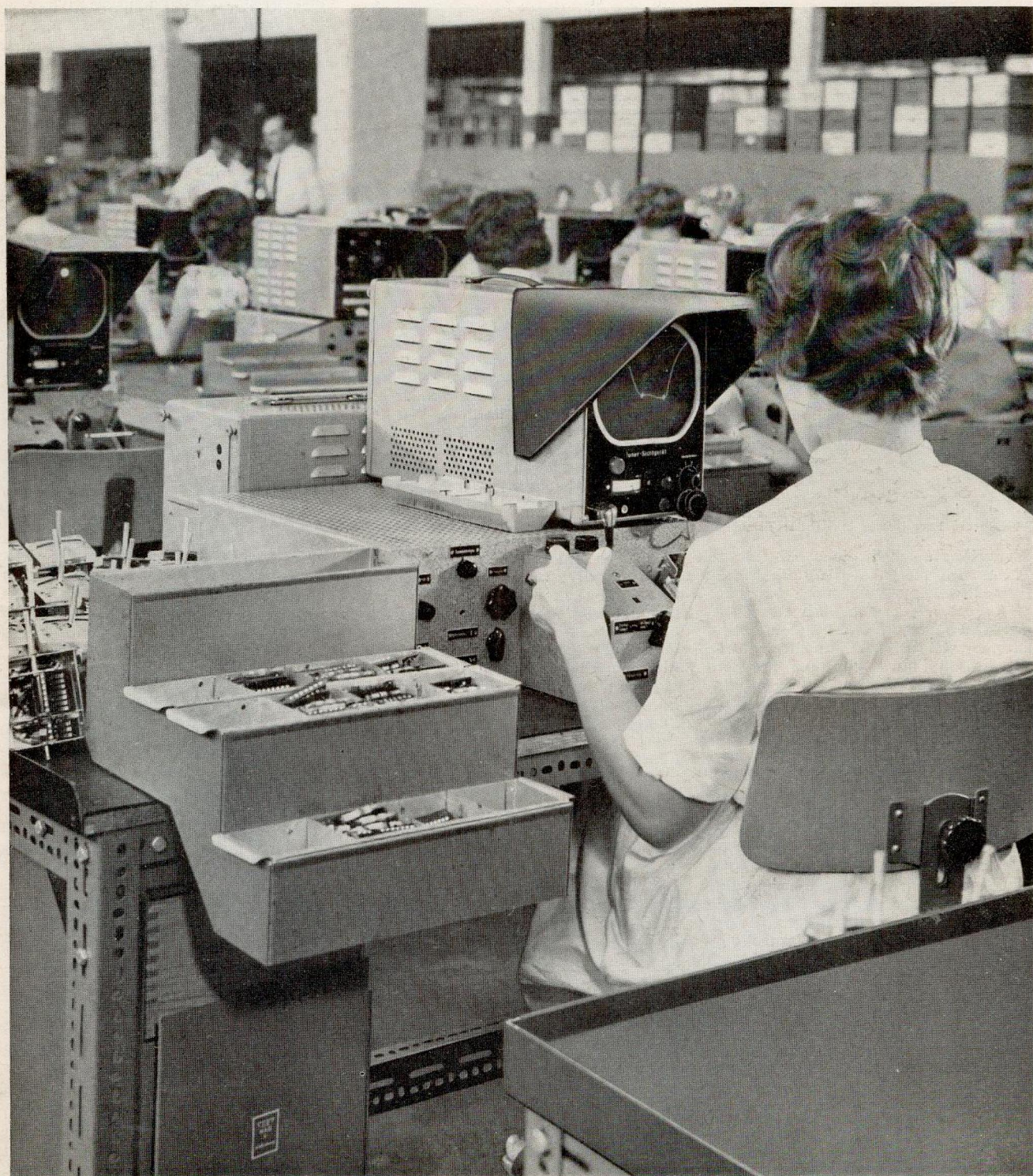
Ein mit neuesten elektronischen Präzisionsgeräten ausgerüsteter Abgleichplatz für den VHF-Kanalwähler im Fernsehwerk
