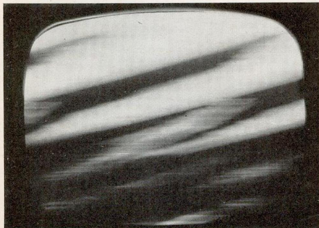
Bild 149: Die diagonalen Streifen verraten dem Techniker, daß die Zeilen-Synchronisation im Kippteil aussetzen muß
