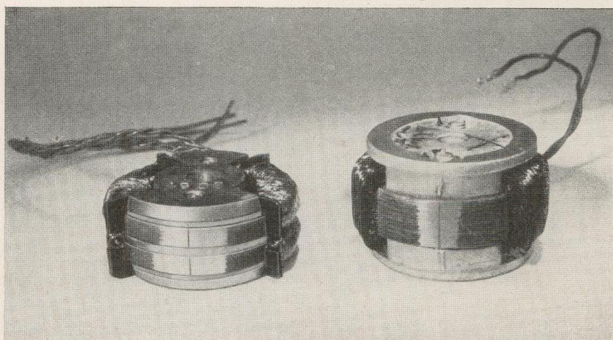
Stereo-Tonbandkopf mit senkrecht übereinander angeordneten Spalten (links) und ein normaler Vollspur-Kopf für Einkanal-Übertragung (rechts)
