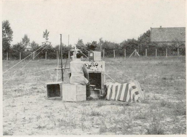
Bild 6: Nahaufnahme des Platzes zum Bestimmen der Störstrahlung nach den Bundespost-Empfehlungen
