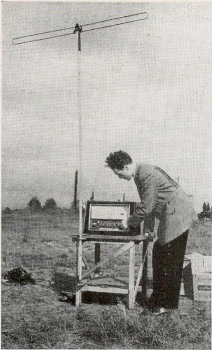
Bild 2: Zu prüfender Empfänger mit angeschlossenem Faltdipol auf metallfreiem Tisch
