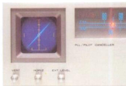
Die Oszilloskop-Anzeige der Marantz-Receiver.
