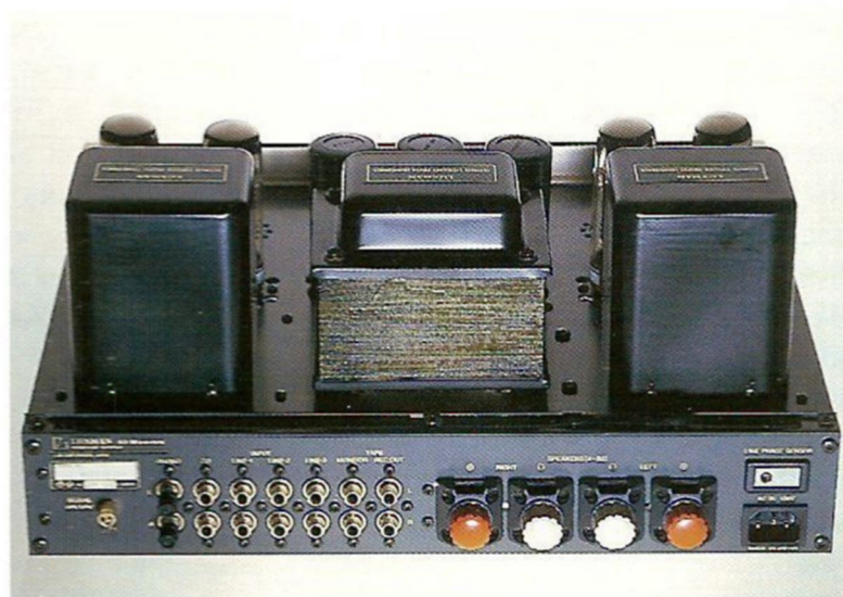
Leider gibt's nur Klemmanschlüsse für die Lautsprecher – dafür entschädigt aber die Netzphasenanzeige mit Hilfe der kleinen silberfarbenen Kontaktplatte über der Kaltgerätebuchse
