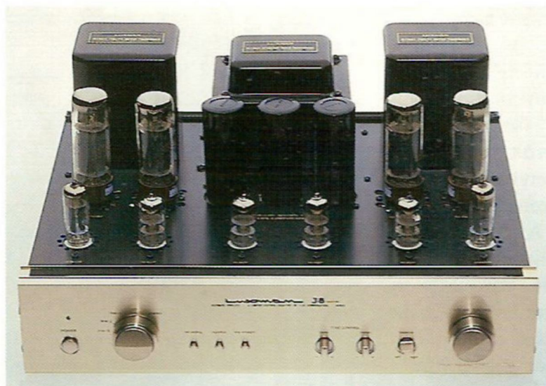
Ohne Deckel – da lacht das Herz des Röhrenfreaks. Sicherheits-technische Erwägungen sprechen allerdings gegen einen „offenen“ Betrieb von Röhrengeräten
