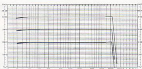
Diagramm 1: Frequenzgang des C-1000 bei Mittelstellung aller Klangregler, und bei 1 Volt, = 10 dB sowie = 20 dB
