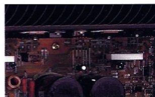
Aufbau der Verstärker-Endstufen mit diskreten Bauteilen
