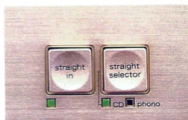
Separate Schalter für die Phono- und CD-Direkt-Betriebsart
