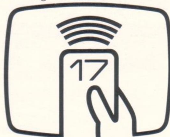
Fernbedienung mit 17 Funktionen: 8 Programme, Norm-Taste, Lautstärke, Helligkeit, Farbstärke, Ein/Aus.
