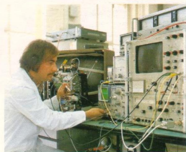
In 1000- und 240-Stunden-Dauertests wird die Zuverlässigkeit der Loewe Fernseher ständig geprüft.
