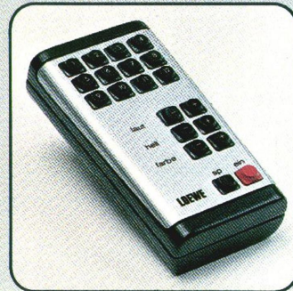
Ultraschall-Fernbedienung »Teleoptimat-T« mit 12 Programm-Direktwahl-Tasten und 8 weiteren für alle wichtigen Einstellungen.
