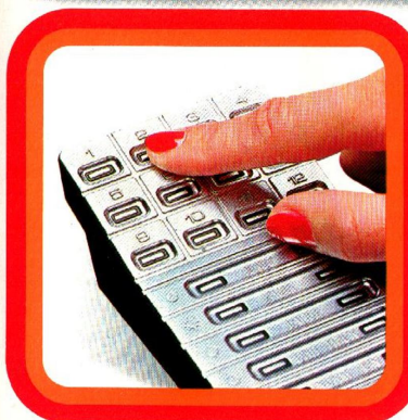
Total sensorgesteuerte Ultraschall-Fernbedienung »Teleoptimat-S« mit 22 Steuerfunktionen.
