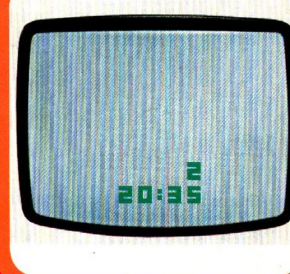
Uhrzeit- und Programmanzeige in großen, grünen Ziffern im Bild einblendbar, durch Fernbedienung oder Sensor am Gerät.
