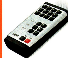
Die Ultraschall-Fernbedienung »Tele-optimat-T« mit 20 Funktionen in Direktwahl: 12 Programme, Ein/Aus, Lautstärke, Helligkeit, Farbkontrast sowie »Testomatic« für Ideal-Grundeinstellung oder »Time« für Zeit- und Programmanzeige (bei Geräten mit Digitaluhr).
