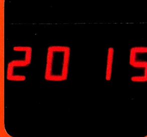
Elektronische Digitaluhr für wechselweise Zeit-, Datums- und Programmanzeige und zur Programmierung gewünschter Ein- und Ausschalttermine.
