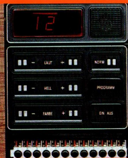
Total-Sensor-Bedienung am Gerät und verdeckte Sender-Programmierung.
