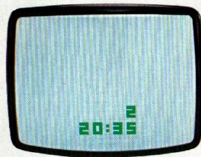
Wahlweise Einblendung der Programm-Anzeige und der Uhrzeit im Bild.
