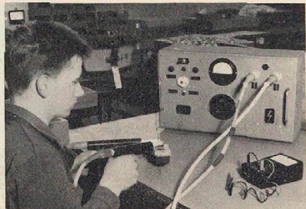
Fig. 74 Hochspannungsprüfung an Statoren
