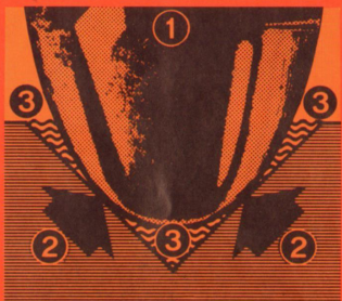
Abtastnadel ① liegt auf Flanken ② der Tonrinne. Nadel gleitet in kühlender Lencoclean-Flüssigkeit ③. Dies schützt Platte und Diamant und verhindert Tonverzerrungen.
