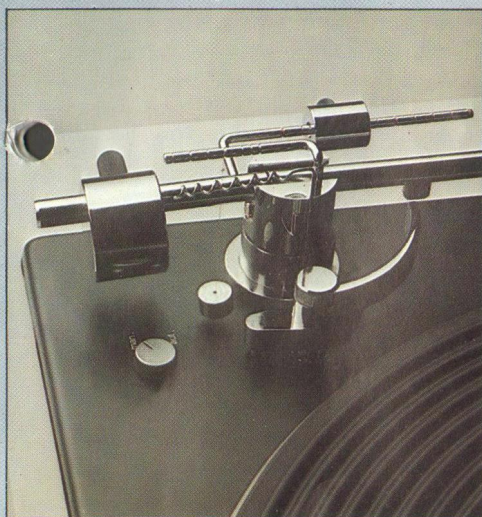
Teilansicht des L 78-Tonarmes mit Gegengewicht, Antiskating-Einrichtung und Laufgewicht. Links im Bild der Drehknopf für automatische oder manuelle Endabschaltung.
