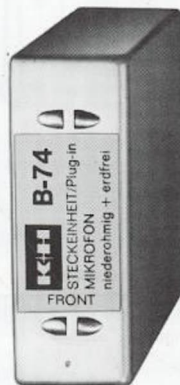
B 74 Mikrofon niederohmig symmetrisch erdfrei mit Übertrager Frequenzgang 20 Hz bis 20 kHz Empfindlichkeit 0,5 mV Eingangswiderstand 1 kOhm Fremdspannungsabstand 60 dB
