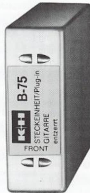
B 75 Gitarre Frequenzgang 20 Hz bis 20 kHz Entzerrung für induktive Abnehmer Empfindlichkeit 8 mV Eingangswiderstand 47 kOhm Fremdspannungsabstand 60 dB
