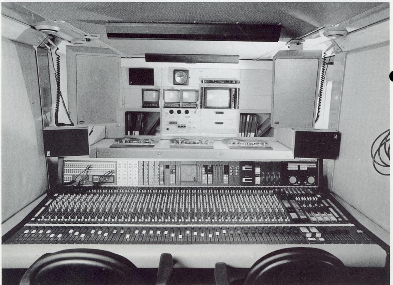
Die SIEMENS AG Wien hat für den Österreichischen Rundfunk (ORF) 10 Hörfunk-Übertragungswagen projiziert und gebaut. Diese nach modernsten technischen Erkenntnissen ausgeführten Wagen sind mit K + H Studio-Regelautsprecher O 96 bestückt und gestatten damit eine Qualitätskontrolle, die der einer Studio-Produktion ebenbürtig ist.
