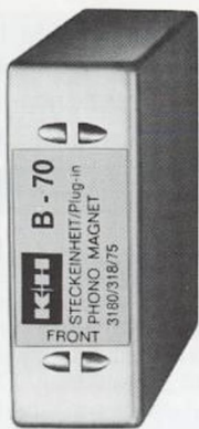
B 70 Phono Magnet Frequenzgang 20 Hz bis 20 kHz Entzerrung nach RIAA/CCIR Empfindlichkeit 2,2 mV Eingangswiderstand 47 kOhm Fremdspannungsabstand 60 dB
